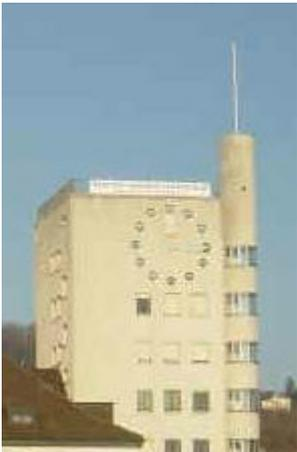
Alles halb so schlimm: Das Uhrwerk musste überholt werden. Die Leuchtzeiger wurden auf die moderne und energiesparende LED Licht-Technik umgestellt. Am 23. Januar 2008 wurden die Zeiger wieder montiert. Die Zeit in Wipkingen läuft weiter...
