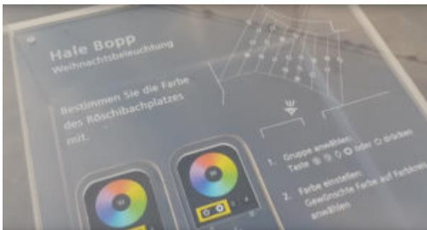
Die 20 Leuchtkörper über dem Röschibachplatz sind in fünf Gruppen zu je vier Leuchten aufgeteilt. Jede Gruppe kann einzeln angewählt und die Farbe am Farbrad eingestellt werden. Bedienung: Gruppen Taste wählen – am Farbrad Farbe auswählen – fertig.
